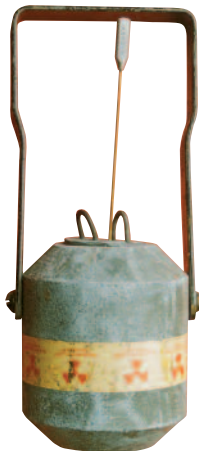
Sonde de Crowe dans son boîtier de protection.
